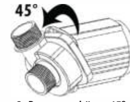
2. Pumpengehäuse 45° drehen im Gegenuhrzeigersinn (links) (nur DM30000S)
